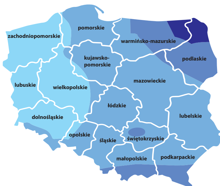
Rys. Strefy przemarzania gruntu w Polsce.
