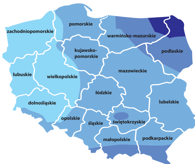
Rys. Strefy przemarzania gruntu w Polsce.
